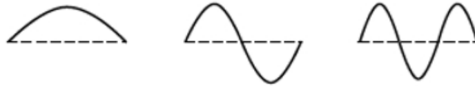
FIGURA 36. Instantáneas de modos 1, 2, 3 de una cuerda vibrando. En cada caso, la cuerda vibra arriba y abajo y su amplitud varía sinusoidalmente con el tiempo. Cuantas más ondas hay, más rápida es la vibración.
